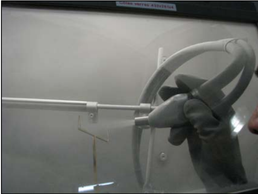
Resim 4: Aparata oluşan fazlalıkların kumlamayla alınması.
