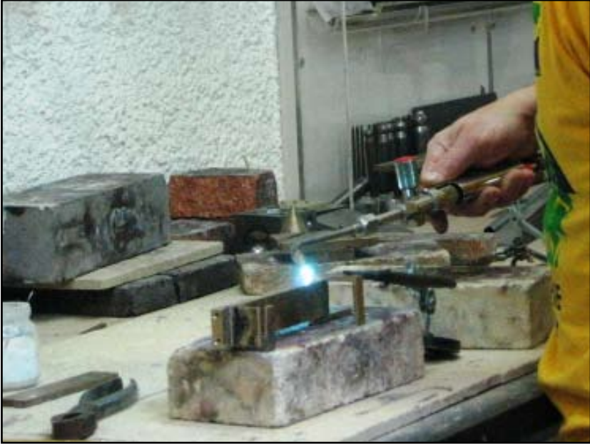
Resim 10: Pirinç kaidenin oksijen kaynağıyla birleştirilmesi
